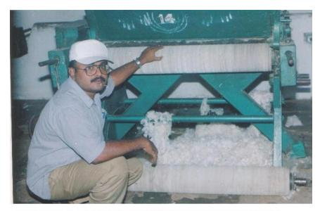
FIGURE 6: UNSAFE CHROMIUM COMPOSITE LEATHER CLAD ROLLERS COMMONLY
