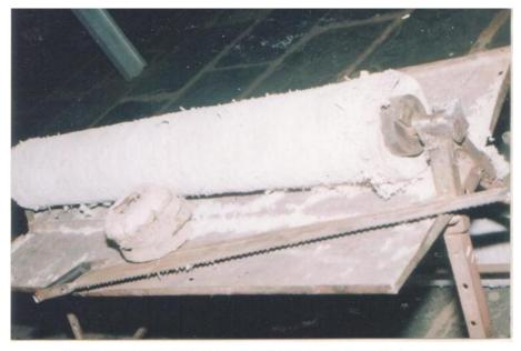
FIGURE 7: FINISHED ROLLER IS READY FOR GROOVING OPERATION USING A BAND SAW
